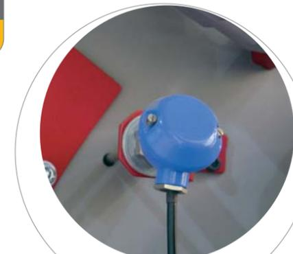
Sonde de température sur chambre de broyage
