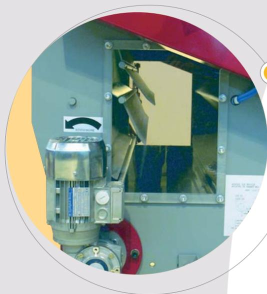
A Ailettes d'orientation de l'entrée d'air
