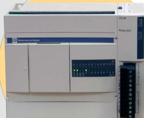
➤ **Système de régulation automatique de débit du distributeur, en fonction de l'ampérage absorbé par le moteur principal du broyeur.**
