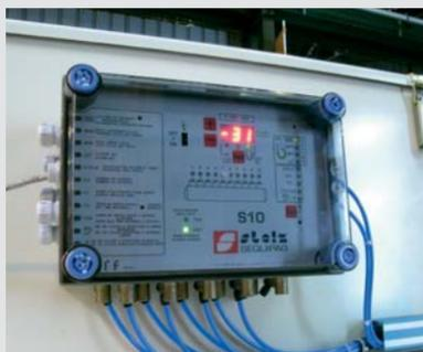
Le cycle de décolmatage est assuré par un séquenceur programmable. Il est possible de sélectionner des séquences rapides entre deux lots, permettant de nettoyer facilement les poches et de réduire le risque de contamination croisée.
