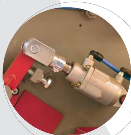
Verrouillage pour étanchéité des grilles
