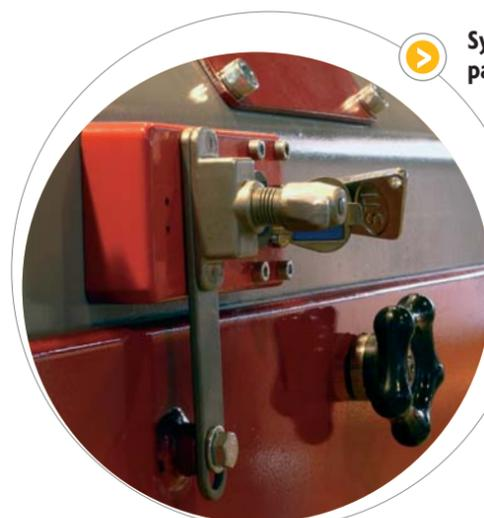
Système d'interverrouillage par transfert de clefs
